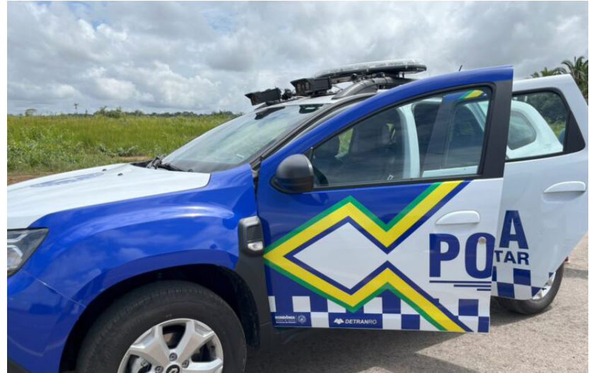
Os veículos são equipados com câmeras OCR para a leitura automática
